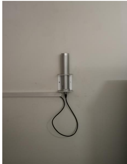
铯源辐照仪室 \gamma 剂量率探头
