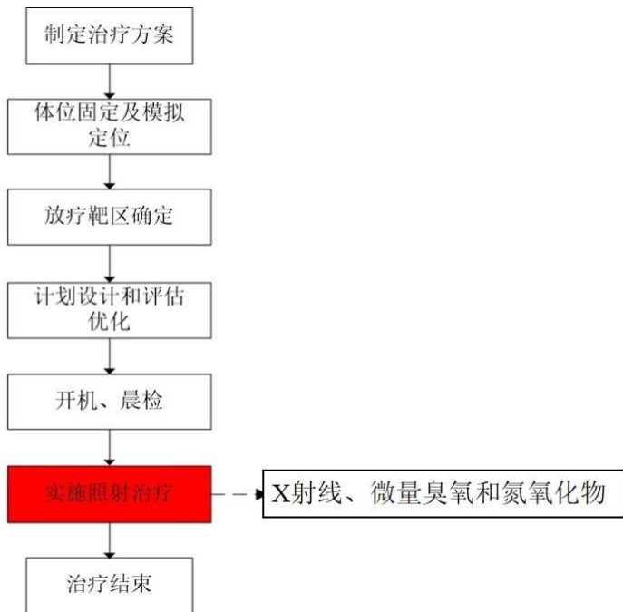
图 2-2 本项目医用电子直线加速器治疗流程及产污环节示意图
